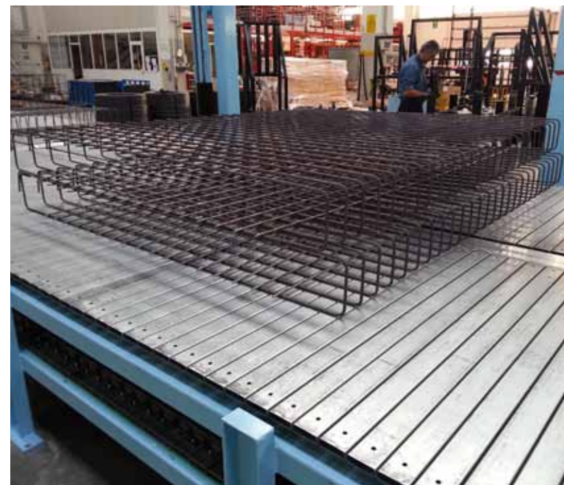
Объемные каркасы для армирования стен произведены и уложены в штабель в полностью автоматическом режиме
