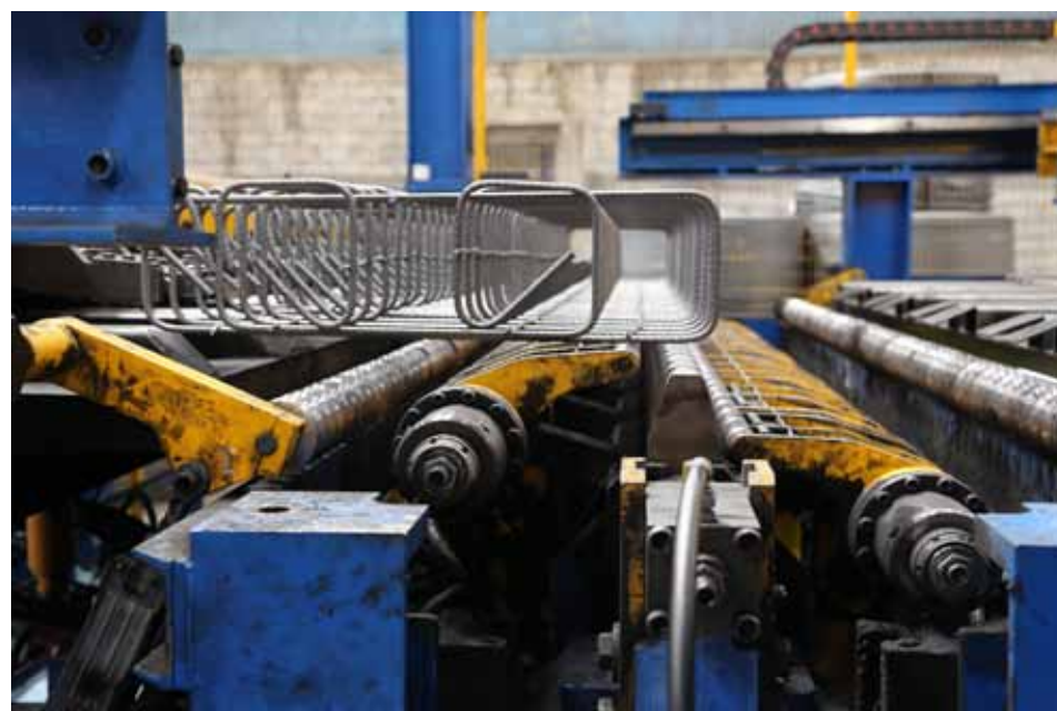
Закрытие наружного каркаса
