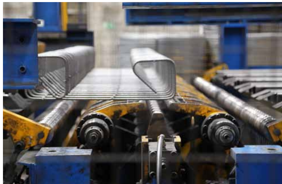
Формирование второгогиба внутреннего каркаса
