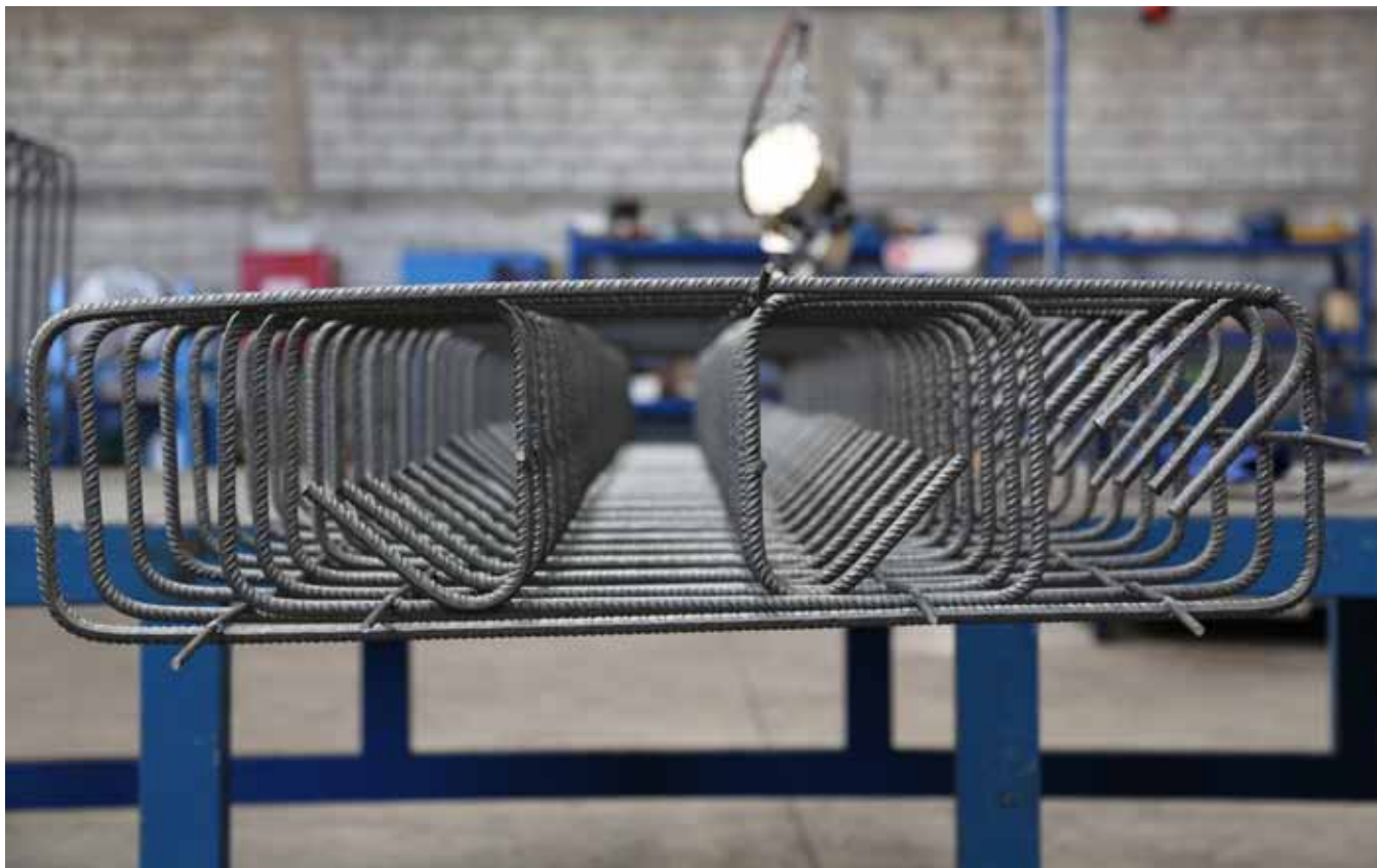
Типичное изделие, произведенное на Syntesis, произведенное в полностью автоматическом режиме
