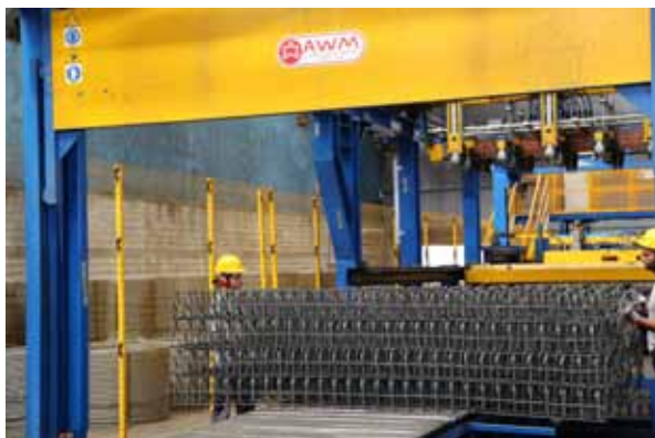
Автоматическое формирование пакета объемных каркасов
