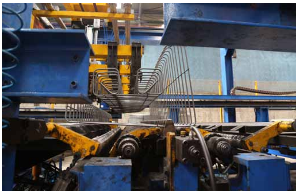
Установка внутреннего каркаса в наружный
